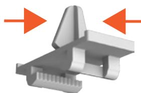
O ST-CLIP pode ser utilizado em perfis de placas metálicas com medidas que vão de 0,6 a 1,2 mm e em furos de 5,5-6,5 mm Ø
